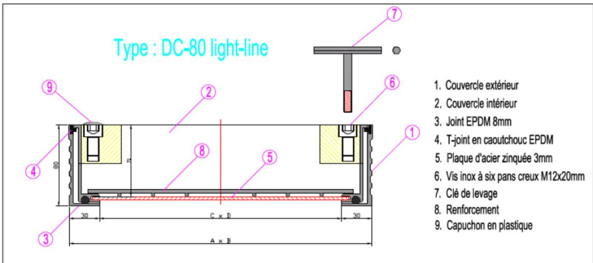
• charge maximale : 40 kN, moyennant un remplissage de béton de min. 4 cm jusqu’au format 600\*600 inclus, 20 kN du format 700\*700 à 1000\*1000.
