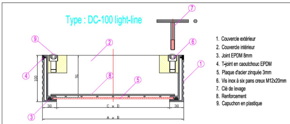
• charge maximale : 40 kN, moyennant un remplissage de béton de min. 4 cm jusqu'au format 600\*600 inclus, 20 kN du format 700\*700 à 1000\*1000.
