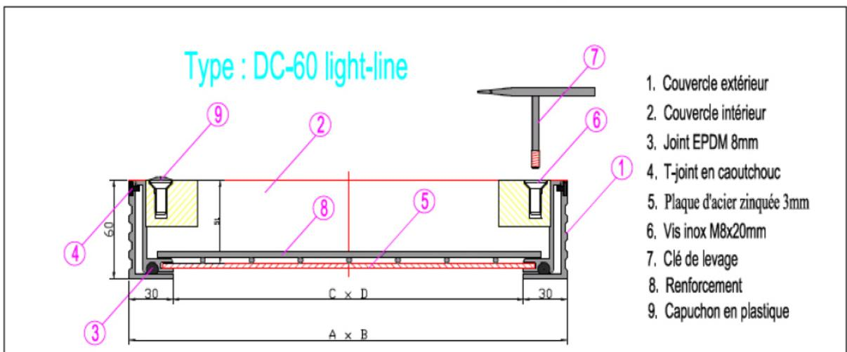
• charge maximale : 40 kN, moyennant un remplissage de béton de min. 4 cm jusqu’au format 600\*600 inclus, 20 kN du format 700\*700 à 1000\*1000
